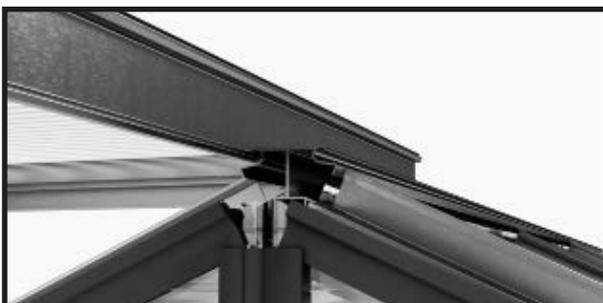
**!** Pour les modèles de couleur, il peut arriver que la peinture appliquée soit un peu trop épaisse et que la fenêtre ne puisse pas être insérée facilement dans le toit. Dans ce cas, prenez un papier abrasif fin et enlevez un peu de peinture sur le cône du profil de la charnière.
