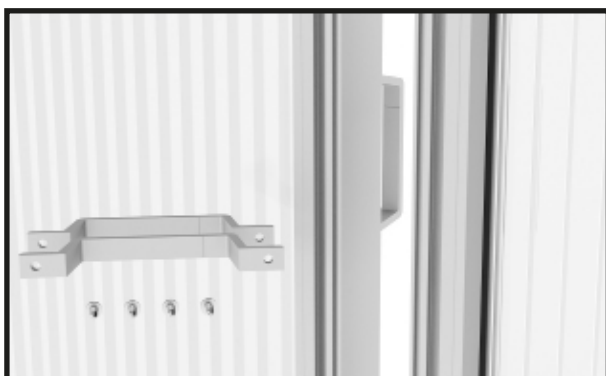
Montez de la même manière les poignées de porte à l'intérieur de la serre.
