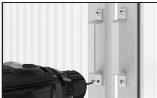
Fixez les poignées de porte avec les vis de 4,8 x 13 mm
