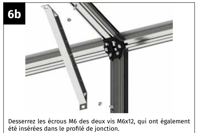
Alignez proprement l'entretoise et vissez-la fermement avec des écrous M6.
