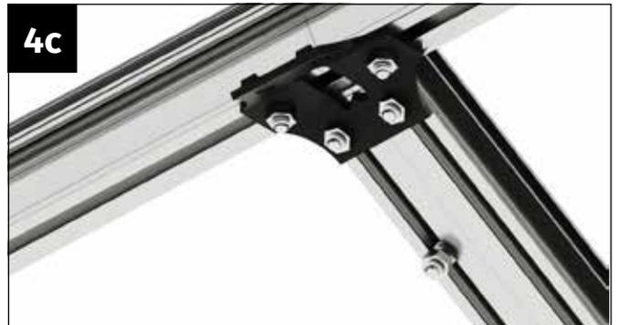
Vissez fermement le profilé de couplage au faîte à l'aide de deux écrous M6. Bloquez la vis restante du canal de vissage gauche avec un écrou M6 pour éviter qu'elle ne glisse.
