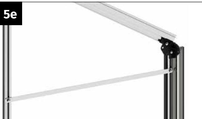
Ajustez le contreventement de manière à ce qu'il soit parfaitement horizontal et vissez-le avec deux écrous M6.
