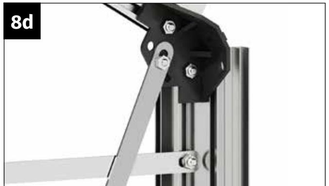
Vissez le contreventement au connecteur d'angle à l'aide d'un écrou M6.
