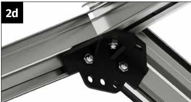
Poussez le profilé de faîtière vers l'extérieur jusqu'à ce qu'il vienne buter contre la butée du connecteur en plastique. Vissez fermement le profilé de faîtière avec un écrou M6.
