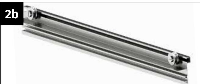
Introduisez l'écrou dans le canal de vissage du rail de guidage de porte. Insérez le boulon d'axe dans le rail de guidage de porte. Vissez le boulon d'essieu avec l'écrou. **Nous recommandons de positionner le galet de porte à environ 30 mm de l'extrémité du rail de guidage de porte et de ne pas le serrer trop fort (il doit pouvoir tourner).** Répéter l'opération sur le deuxième côté du rail
