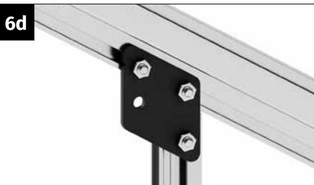
Vissez fermement le connecteur de fixation de l'entretoise avec des écrous M6 sur le profilé de coin de toit et le profilé d'entrée
