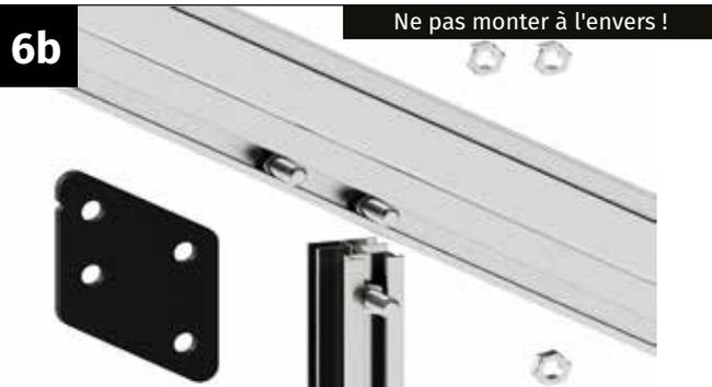
Prenez le connecteur de fixation de l'entretoise ainsi qu'une vis M6x12 mm et un écrou M6. Introduisez la vis dans le canal de vissage de l'entretoise de la paroi arrière.
