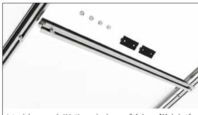
Introduisez une vis M6x12 mm de chaque côté du profilé de butée dans le canal de vis. Insérez une vis en losange dans chaque canal de vis de la barre de toit.
