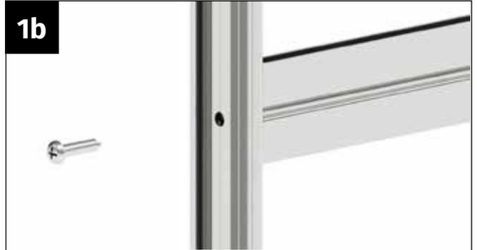
Positionnez le montant de porte sur le côté du profilé de porte de manière à ce que le trou central découpé se trouve exactement au-dessus du cône de vissage du montant de porte.
