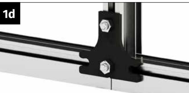
Visser fermement l'entretoise au connecteur en plastique à l'aide d'un écrou M6.
