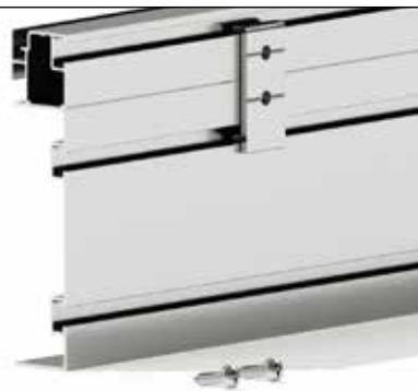
Placez les crochets de fondation à environ 10 cm de chaque extrémité, aussi bien dans le profilé de sol que dans le profil de fondation.
