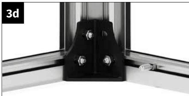
Poussez le profilé de sol vers l'extérieur jusqu'à ce qu'il vienne buter contre la butée du connecteur en plastique. Vissez fermement le profilé de sol avec un écrou M6.
