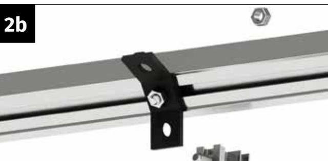
Introduisez une vis M6x12 mm sur le côté supérieur dans le canal de vis de la jambe de force.
