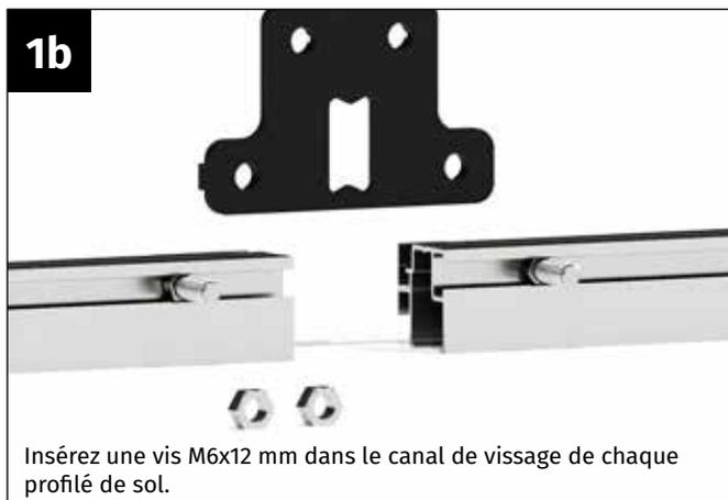
Insérez une vis M6x12 mm dans le canal de vissage de chaque profilé de sol.
