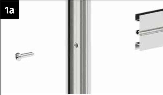
Prenez le profilé de porte sur le côté, le barreau de porte et une vis à tôle 4,2x22 mm.
