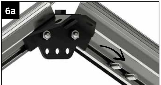
Visser les deux écrous M6 des vis M6x12 mm préalablement introduites dans la zone du faîte et guider les vis vers l'extrémité supérieure du profilé d'entrée de porte.
