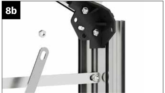
Introduisez la vis M6x12 mm de l'extérieur dans le trou central du connecteur d'angle.
