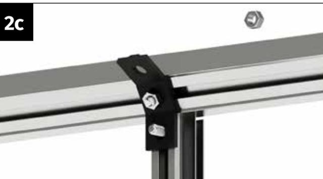
Placez l'entretoise de la paroi latérale sur le connecteur en plastique. Positionnez la vis M6x12 mm dans le trou du connecteur en plastique.
