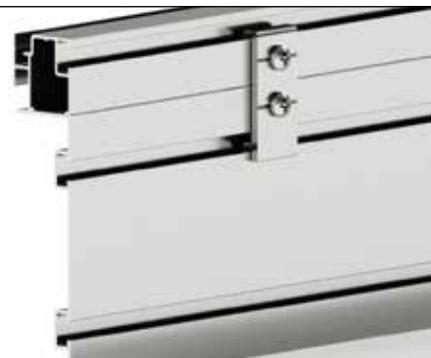
Reliez le crochet de fondation en vissant les vis autoforeuses 4,8x13 mm. Le profilé de sol de longueur 1867 est également vissé au milieu.
