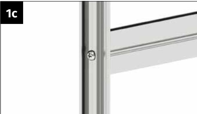
Vissez fermement le profilé de porte latérale au barreau de la porte à l'aide de la vis autotaraudeuse 4,2x22 mm.
