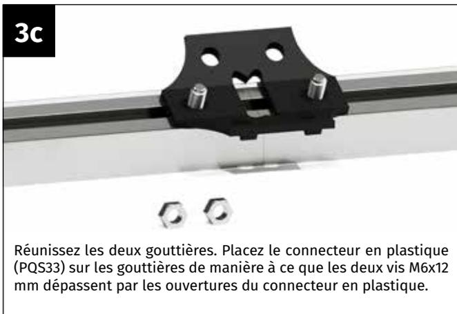
Réunissez les deux gouttières. Placez le connecteur en plastique (PQS33) sur les gouttières de manière à ce que les deux vis M6x12 mm dépassent par les ouvertures du connecteur en plastique.
