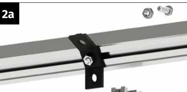
Prenez une vis M6x12 mm et un écrou M6.
