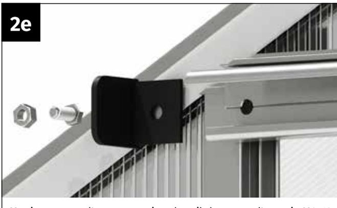
Munissez-vous d'une protection de rail de porte, d'une vis M6x12 mm et d'un écrou M6.
