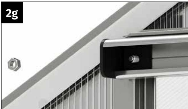
Insérez la vis M6x12 mm par l'arrière à travers le trou du rail de porte et de la protection du rail de porte.
