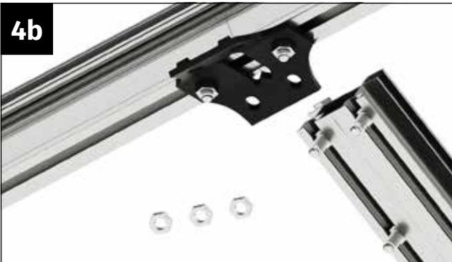
Introduisez deux vis M6x12 mm dans le canal de vis gauche et une vis dans le canal de vis droit du profilé de couplage.
