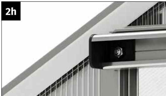
Vissez fermement la protection de rail de porte et le rail de roulement de porte ensemble avec un écrou M6.
