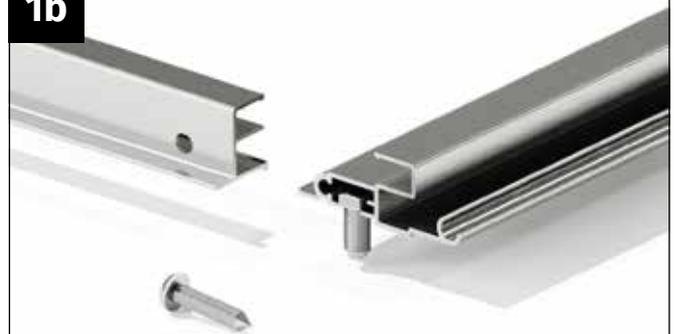
Introduisez les deux vis M6x12 mm dans le canal de vissage du profilé de charnière.
