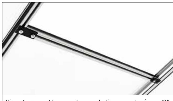
Vissez fermement le connecteur en plastique avec des écrous M6. Veillez à ce que la vis en losange se coince dans le canal de vissage de la barre de toit !
