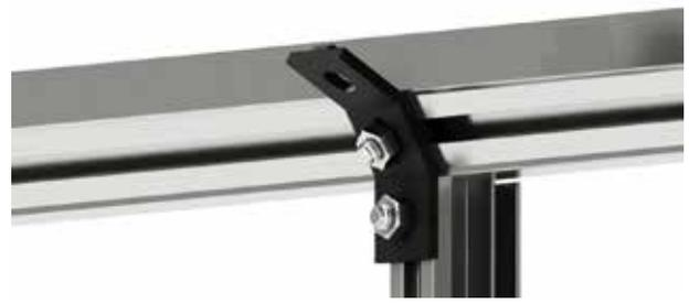
Introduisez la vis M6x12 mm sur la face inférieure dans le canal de vis de la barre de toit.
